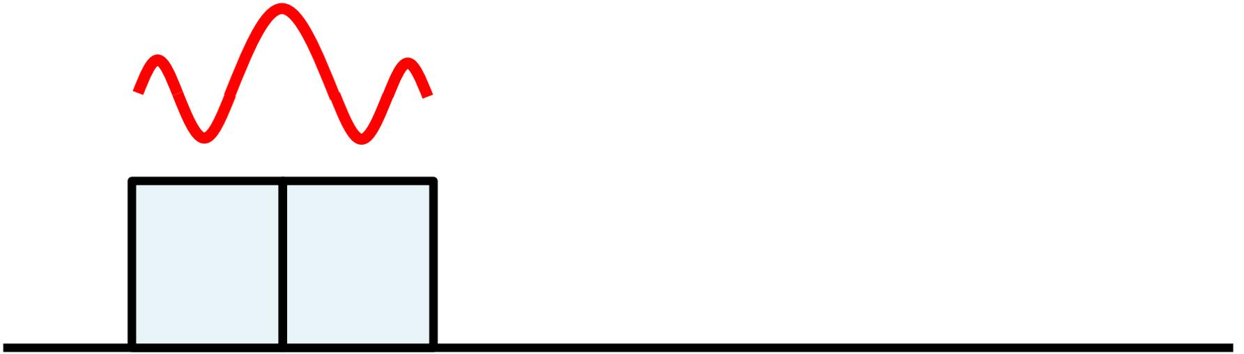
**RFと傾斜磁場が作るスライス選択面内の周波数帯域が一致することが条件**
